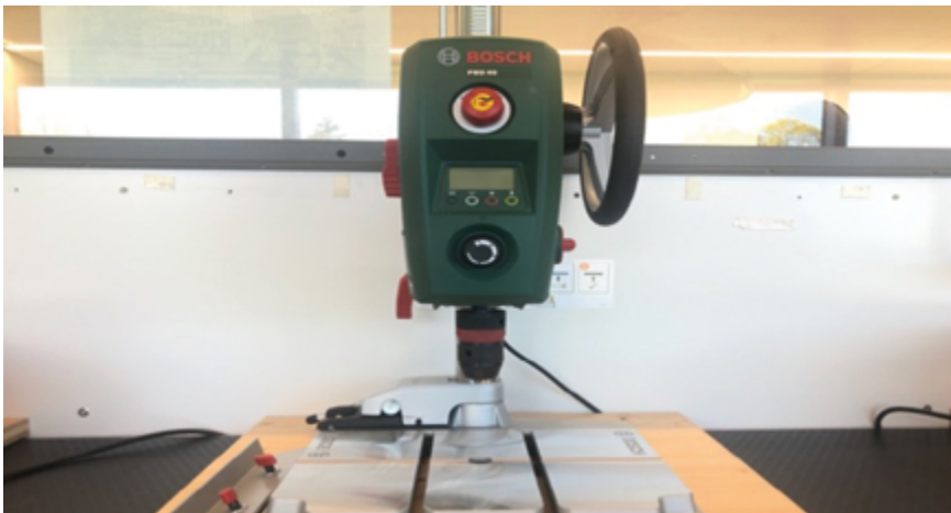
BOHRMASCHINE MIT DREHZAHLEREGULIERUNG
