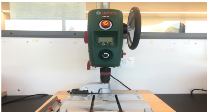
BOHRMASCHINE MIT DREHZAHLREGULIERUNG
